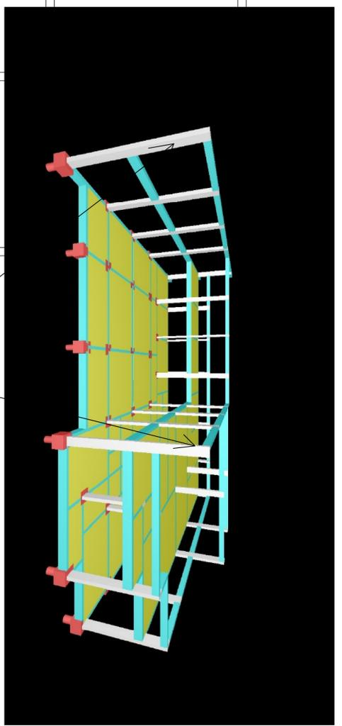
Local de fixação dos consoles metálicos para parafusamento das tesouras.
